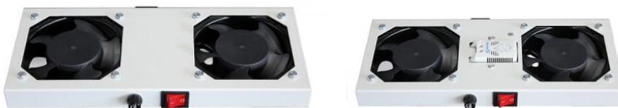
Предназначены для обеспечения вентиляции установленного оборудования в телекоммуникационных настенных разборных шкафах. Устанавливается в специально подготовленные отверстия в верхней части шкафа с помощью 8-ми винтов М5х12 и стопорных шайб, входящих в комплект поставки. Шнур подключения в комплект поставки не входит.
